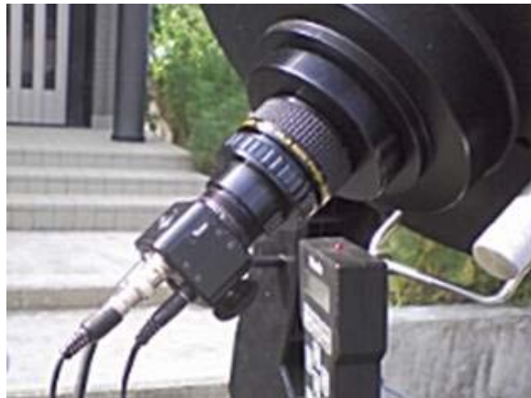
図一六 望遠鏡に接続したWAT-100N 接眼部にはF10をF3.3にするフォーカルレデュースを取り付けています
