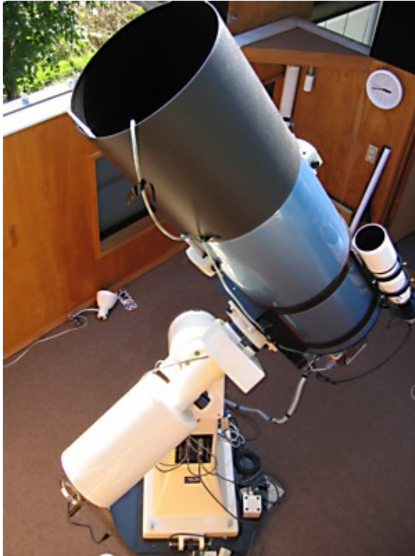
望遠鏡 口径36cm F8 リッチークレティアン 赤道儀 ドイツ式、自動導入
